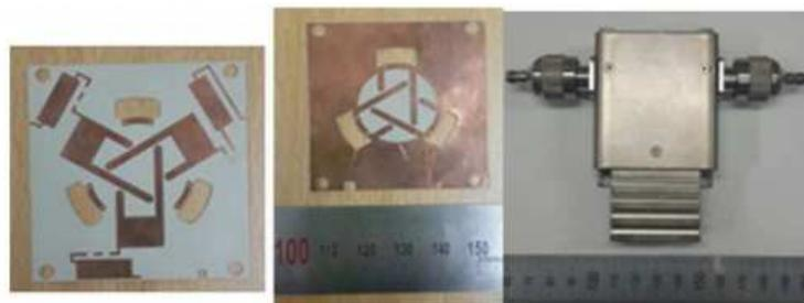
그림 65. Isolator Center Network와 기구 제작 사진.
