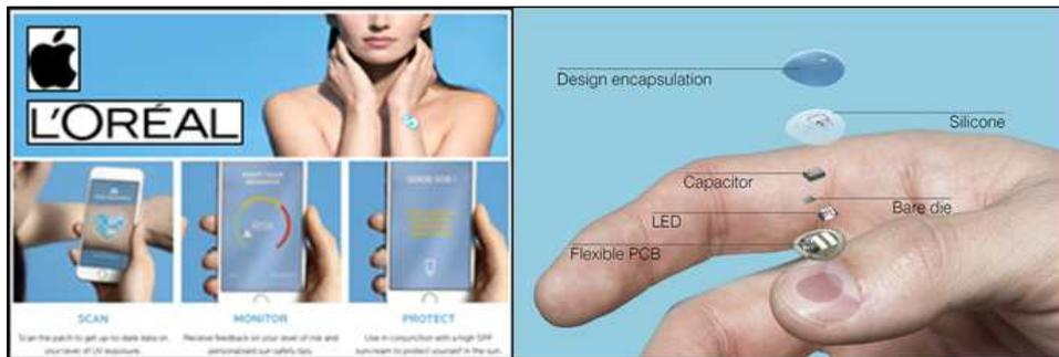
그림 55. Battery-free UV 센서 제품.
